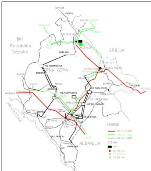
Slika 09: Konfiguracija prenosne mreže Crne Gore 2020. godine (prostorna šema) u scenariju sa izgrađenom TE Pljevlja 2, HE Andrijevo, HE Zlatica, HE Raslovići, HE Milunovići i HE Komarnice
